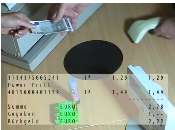
Beispiel: Scrollfeld-Darstellung eines Bondruckers
